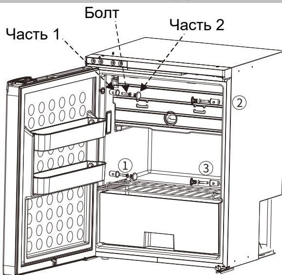
Часть 1 закреплена на холодильнике. Чтобы закрепить холодильник в нише, нам нужно просверлить отверстие в Части 1, вкрутить болт через Часть 1 и закрепить его на стене, используя Часть 2, чтобы закрыть отверстие. Требуется болт с резьбой ниже MS и длиной более 15 мм (Болт не входит в комплект).
