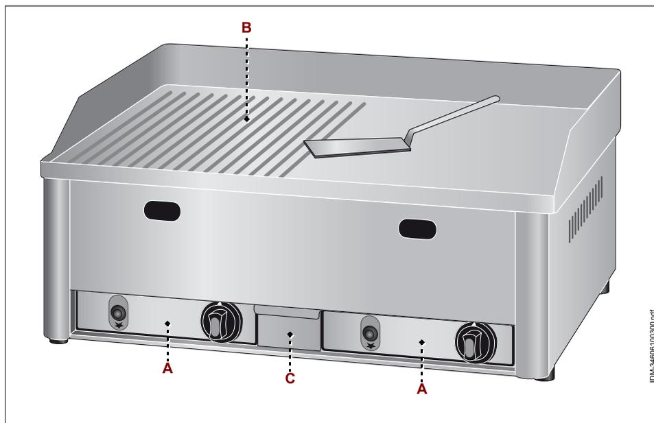
**А) Щит управления:** оснащен органами для управления работой прибора (см. "Описание органов управления").
